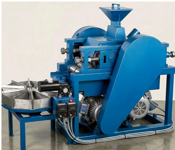
Chancadora de rodillos TCR con tolva de alimentación, guarda de transmisión y divisor rotatorio de 8 segmentos acoplado (opcional)
